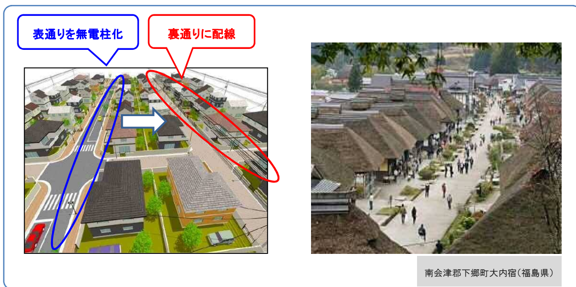
図 3-3 裏配線方式イメージ
