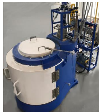
自社製熱交換器搭載省エネルギーバーナを搭載「アルミ溶解るつぼ炉」
