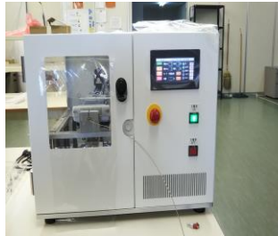
透析排液に含まれる大量の無機塩を連続的に除去するための、脱塩チューブ自動切換え装置全景。透析装置と質量分析計の間に設置して用いる。
