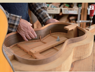
1 厚生労働省認定「現代の名工」受賞時の盾 2 スペイン式クラシックギターの制作過程。ボディの外側から木を叩き、音を確かめながら調整を繰り返す。
