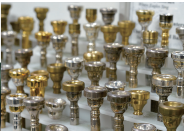
工房内に置かれた様々なメーカーのサンプル用マウスピースは500種類近くある。サンプルをもとに、演奏者の要望に合わせて独自の型に削っていく。
