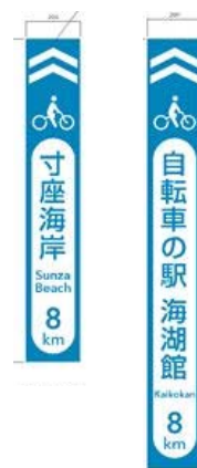
距離付き方向誘導路面標示
