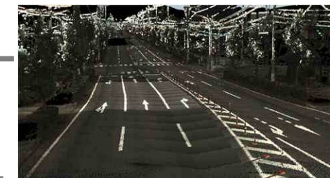
図: 3D道路モデル(点群データ)
